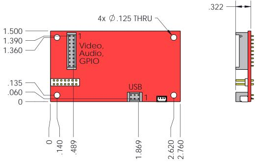
A/V,GPIO Connector: Hirose: DF11-18DP-2DSA-01 USB Connector: Hirose: DF11-6DP-2DSA20
