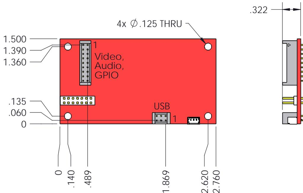
A/V,GPIO Connector: Hirose: DF11-18DP-2DSA-01
